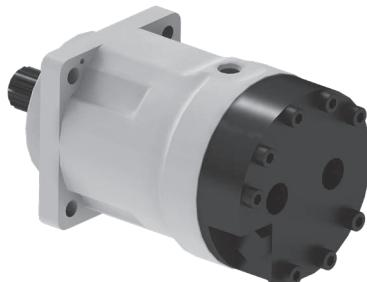
Гидромотор со встроенным промывочным клапаном предназначен для преобразования входной гидравлической мощности в выходной момент, который используется для выполнения требуемых механических операций. Промывочный клапан удаляет из рабочего контура через корпус гидромотора часть рабочей жидкости для ее дальнейшего охлаждения.
