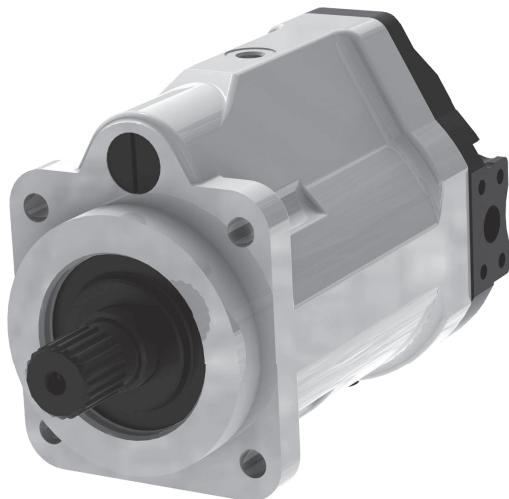
Гидромотор предназначен для преобразования входной гидравлической мощности потока рабочей жидкости в выходной крутящий момент на его валу. Гидромоторы аксиально-поршневые регулируемые предназначены для работы в открытых контурах для установки в гидросистемах погрузчиков, автокранов, экскаваторов, комбайнов и другой дорожно-строительной, подъемно-транспортной, сельскохозяйственной техники и машиностроительного оборудования.
